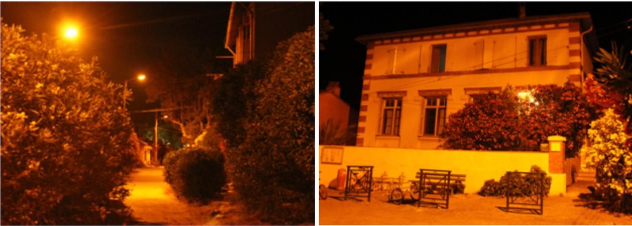
**Figure 10 : Puissance installée trop élevée du fait du sol en terre battue avec fort coefficient de réflexion et mauvaise orientation des flux (lumière intrusive, éclairage important des façades de bâtiments et des éléments naturels : arbres, haies et arbustes à fleurs).**
