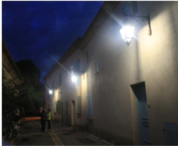
**Figure 6 : Luminaires de style sans réflecteur optique à parois vitrées avec lampe fluocompacte verticale apparente : flux perdu, lumière non dirigée, lumière intrusive, éblouissements, encrassement des parois en verre (entretien et perte rendement) et diffusion de la lumière vers le haut par le verre.**
