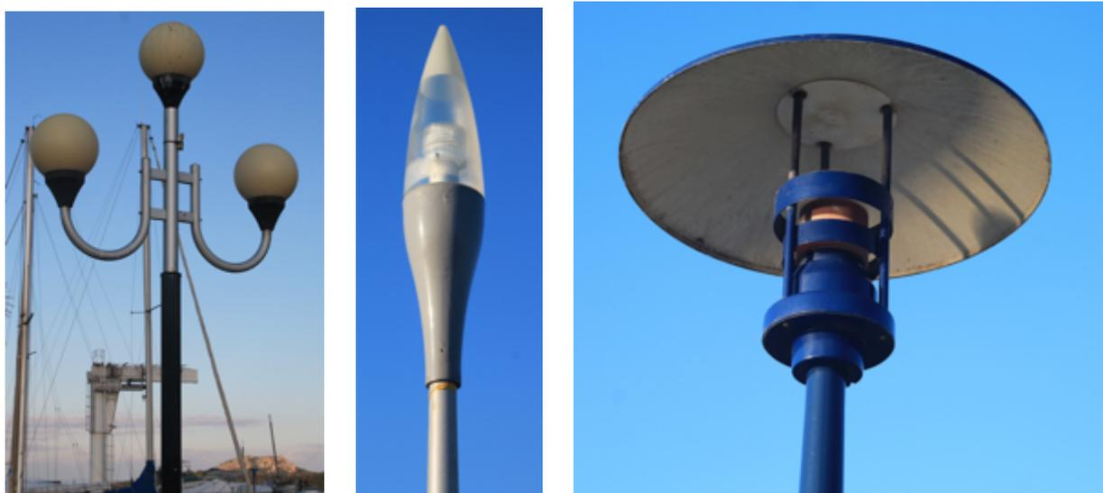
**Figure 23 : Trois modèles différents de luminaires installés sur le périmètre du port de Porquerolles. De gauche à droite : triple « boules lumineuses » équipées de lampes à vapeur de mercure haute pression, luminaire « Spike » équipé d'une lampe aux iodures métalliques et luminaire « Johanna » équipé d'une lampe au sodium haute pression.**
