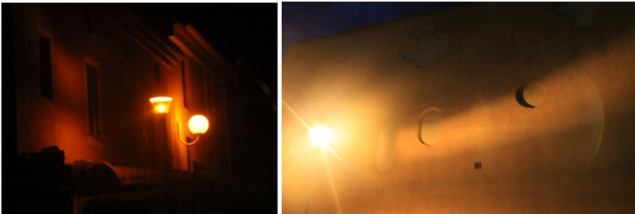
**Figure 11 : A gauche : deux types de luminaires, un luminaire « boule » et son remplaçant récent « le Nella » ; le flux perdu directement à la verticale est plus faible pour ce dernier puisqu'il dispose d'un réflecteur mais, comme le montre l'image de droite, il reste un flux latéral perdu très important qui peut se propager directement à grande distance longitudinalement à la rue ou qui éclaire les fenêtres des résidences.**
