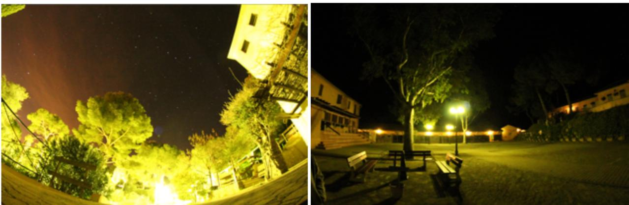
**Figure 32 : A gauche : panorama à proximité de l'entrée de l'IGESA illustrant les pertes de flux et les illuminations des façades et des arbres. A droite : cour intérieure de l'IGESA avec des lanternes de styles avec ampoule verticale éclairant l'arbre jusqu'à sa cime ainsi que les façades des appartements en location**
